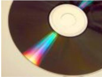
Il disco ottico è una tipologia di supporto di memoria. È costituito da un disco piatto e sottile in genere di policarbonato trasparente. Al suo interno è inserito un sottile foglio metallico, in genere di alluminio, su cui vengono registrate e lette le informazioni tramite un raggio laser.
